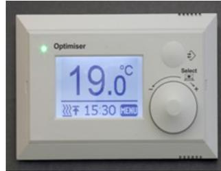
Die abgesetzte Bedieneinheit kann auch die Funktion der Wohnungsstation übernehmen und verfügt deshalb über einen eingebauten Raumtemperaturfühler. Im Gegensatz zur Wohnungsstation werden die Daten der Bedieneinheit jedoch digital übertragen; eine Funktionsprüfung des Raumtemperaturfühlers mit bauseitigen Messmitteln ist daher nicht möglich.
