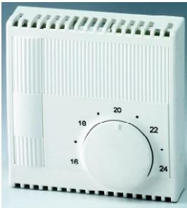
Die Wohnungsstation dient der Erfassung der Raumtemperatur und kann mit einem Ohmmeter geprüft werden. Den Stellknopf hierzu auf 20°C drehen und, je nach aktueller Raumtemperatur, den gemessenen Wert mit der nachfolgenden Tabelle vergleichen. Zur Messung muss die Verbindung zwischen Wohnungsstation und Optimiser abgetrennt werden.
