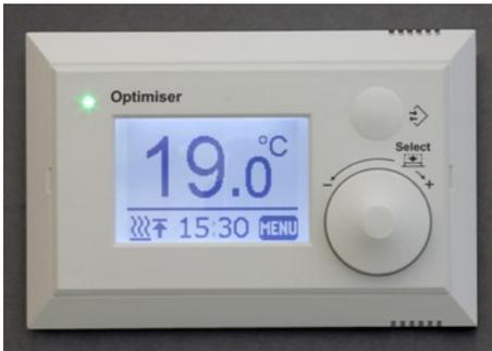
Die abgesetzte Bedieneinheit wird auf dem mitgelieferten Montagerahmen befestigt, der für Montage auf der Wand mit Kabeleintritt von oben oder unten bzw. auf einer Unterputz-Schalterdose mit Kabeleintritt von hinten geeignet ist. Angeschlossen wird die Bedieneinheit über ein vieradriges Kabel; hierzu eignet sich ein handels-
