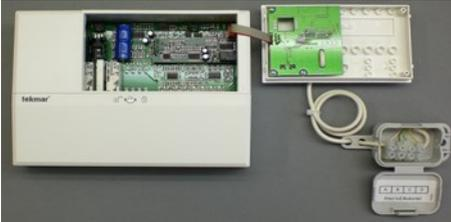
Die Standardanzeige der abgesetzten Bedieneinheit unterscheidet sich von der des lokal montierten Regler-Bedienteils dadurch, dass im oberen Teil der Anzeigefläche mit großen Ziffern die tatsächliche Raumtemperatur angezeigt wird. Zur Ermittlung dieser Temperatur dient ein Temperaturfühler, der sich im Montagerahmen der abgesetzten Bedieneinheit befindet.
