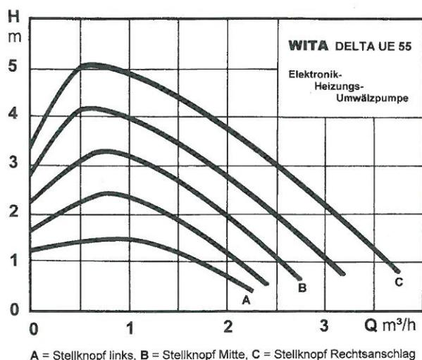
Mit dem Einsteller an der Pumpe kann eine Feineinstellung der Förderhöhe vorgenommen werden. Die Leuchtdiode signalisiert den Betriebszustand.
